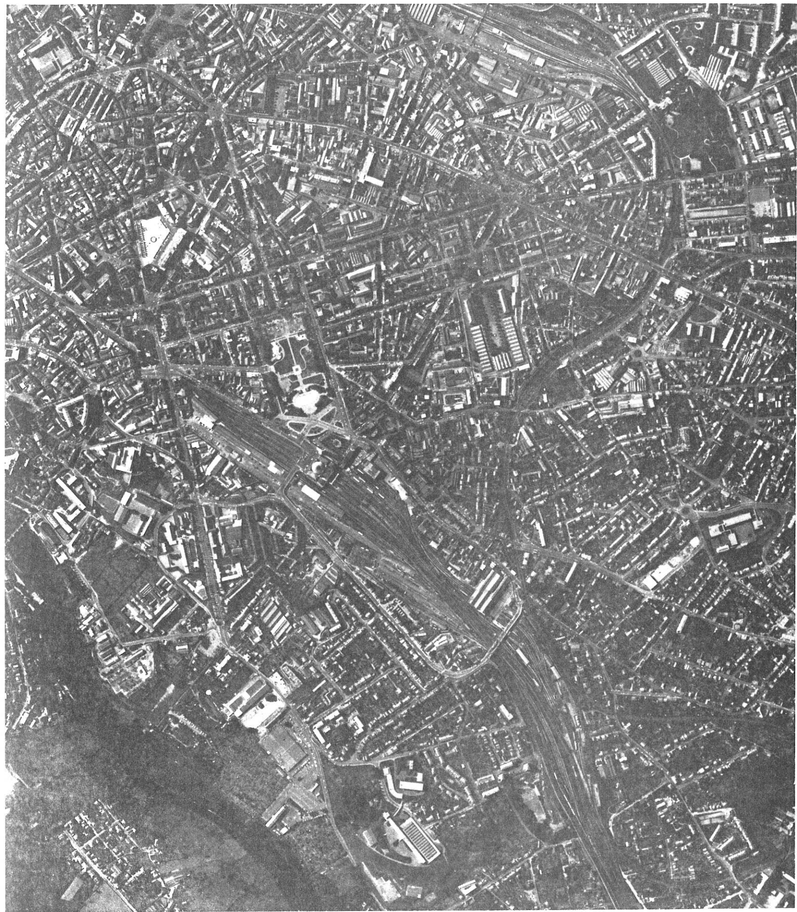
Photographie aérienne de (France) prise à haute altitude (36 000 pieds) avec une chambre de 610 mm directement à l'échelle 1/18 000.
